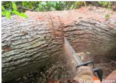
Effectuer un premier trait de scie jusqu'à la moitié du diamètre au point de tronçonnage. Ensuite, effectuer un second trait de scie aux deux-tiers du diamètre afin de libérer les points de tension et de compression.
